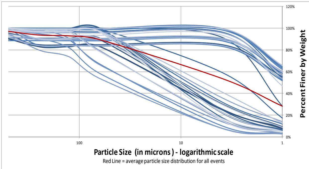
Figure 4.2.1d. Average Influent Versus Effluent Particle Size Distribution Data
