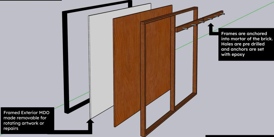
MULTI LAYERED EXTERIOR GRADE PLYWOOD CONSTRUCTION
