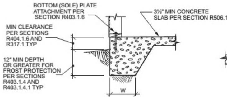
1 MONOLITHIC SLAB-ON-GROUND WITH TURNED-DOWN FOOTING
